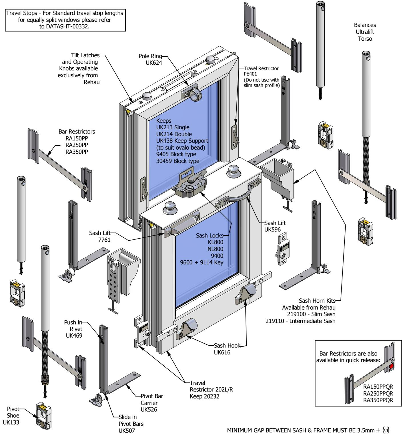
MINIMUM GAP BETWEEN SASH & FRAME MUST BE 3.5mm ± 0.0
